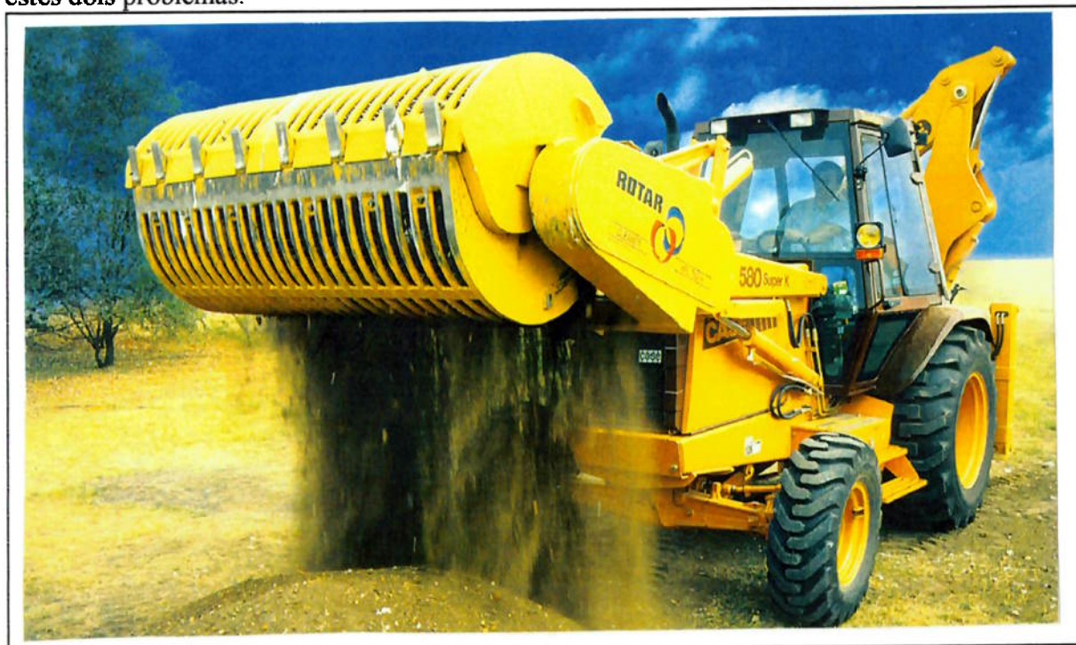
Figura 1.2-1 - Equipamento ROTAR para instalação em tratores. Com movimento giratório da caçamba com uma malha para peneiramento é feita a separação do material por diferença granulométrica. [3-catálogo da empresa]
